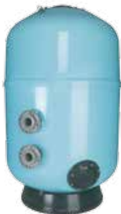
Filtre à sable Europe en polyester renforcé avec finition extérieure en gel coat et la possibilité de choisir sa couleur. Disponibles du diamètre 1050 mm à 2500 mm, avec des hauteurs de filtration de 1 ou 1,2 m et avec des pressions de travail de 2,5 ou 4 kg/cm 2 . (AstralPool)
