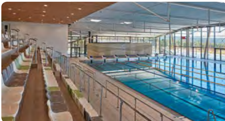
Le bassin intérieur de 33m est équipé d'un mur mobile permettant de proposer 1 bassin de compétition de 25m et 1 bassin d'activités de 8 x 21m avec fond mobile.
