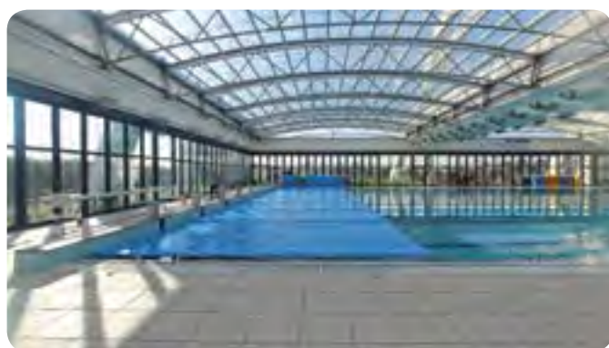
Piscine olympique de Campodarsego (PD). Couvertures indépendantes en mousse (Corex65) et 2 enrouleurs motorisés mobiles modèle MNR.
