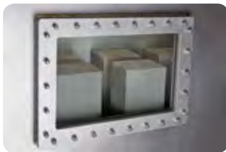
Avec un module (2 000 x 1 800 x 650 mm) intégrant 12 membranes Crystar® HiPur par exemple, une capacité de filtration de 72 m 3 /h peut être assurée. Avec ce même module comportant 12 membranes Crystar® HiFlo, la capacité de filtration atteint alors 168 m 3 /h.
