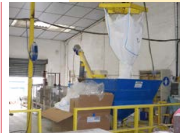
Conditionnement des granulés (Le sac suspendu, « big bag » contient 1 tonne de produit)
