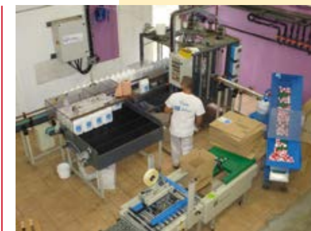
Conditionnement automatique des bidons de 5 litres (3 000 litres à l'heure)
