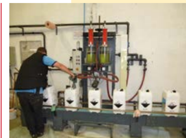
Conditionnement du chlore liquide en 20 litres.
