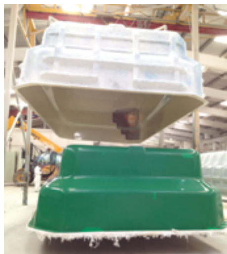
Démoulage d'une coque polyester (Piscines Groupe G.A.)
