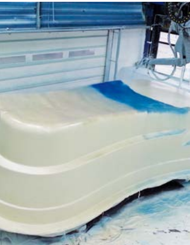
Phase 3 : Projection du barrière coat
