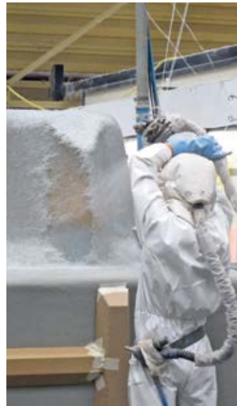
Après la pose des moules de renfort, début de projection
