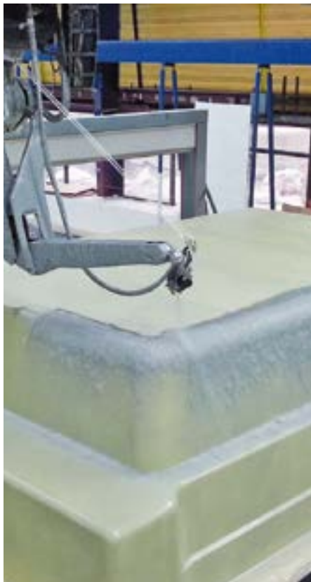
Phase 4 : Projection simultanée polyester/fibres
