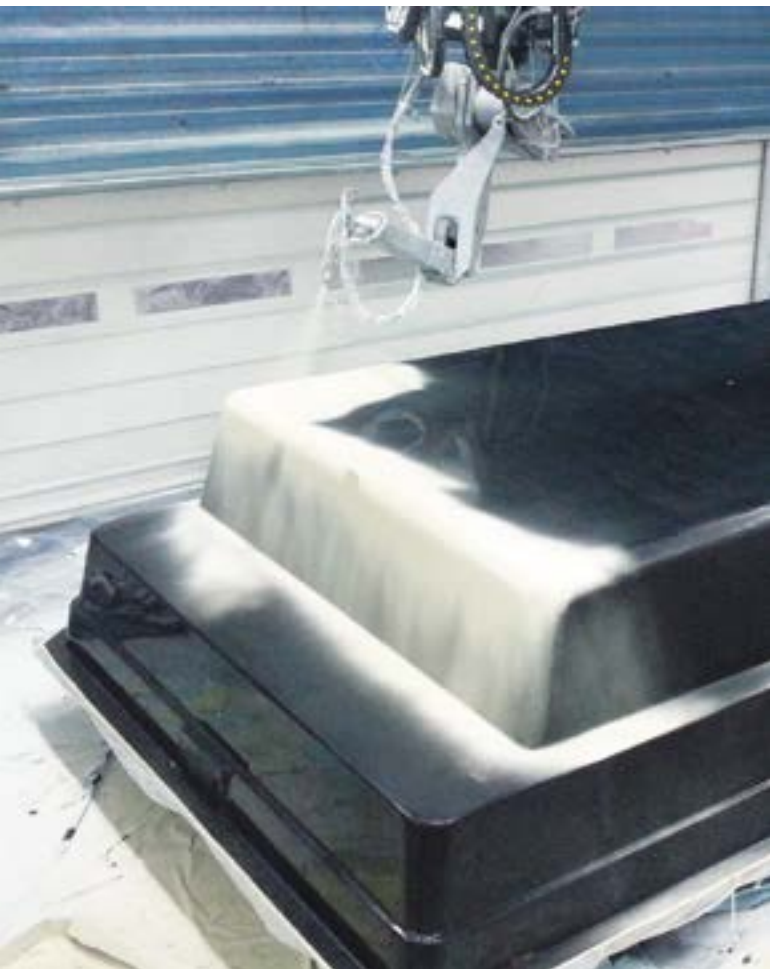
Phase 2 : Projection du gel coat
