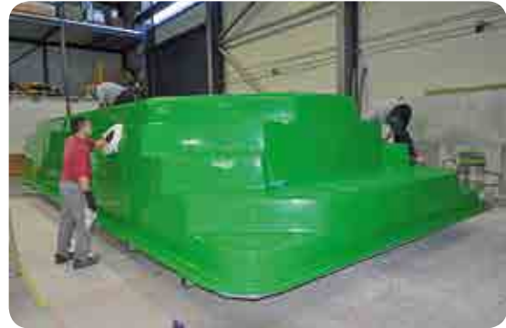
Cirage du moule de la MANUA
