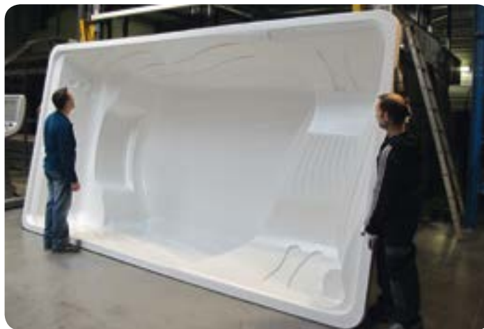
Mini piscine Pretty Pool après thermoformage
