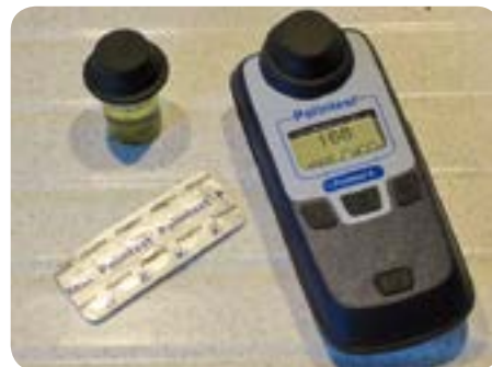
La mesure donne : TAC = 168 mg/L = 16,8 °F, soit 17°F
