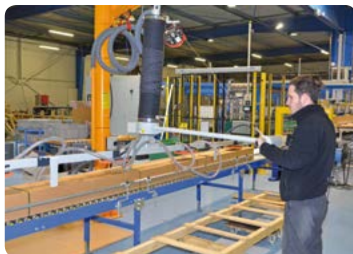
Palettisation assistée des paquets de lames
