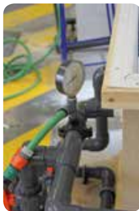
Contrôle de l'étanchéité hydraulique par mise en pression d'eau.
