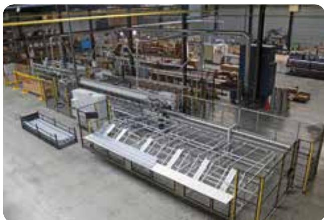
T&A a par ailleurs installé cette année **deux nouvelles lignes de fabrication entièrement automatisées, augmentant ainsi ses capacités et diminuant ses délais de production.** Equipées de machines à soudure à ultrason, ces nouveaux outils de production garantissent une haute qualité de finition, ainsi que des délais fiables.
