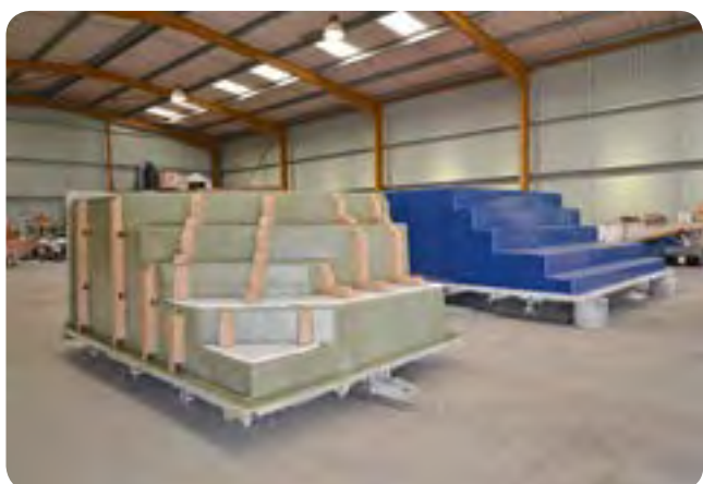
À gauche le commencement des positionnements des renforts et à droite on aperçoit un moule
