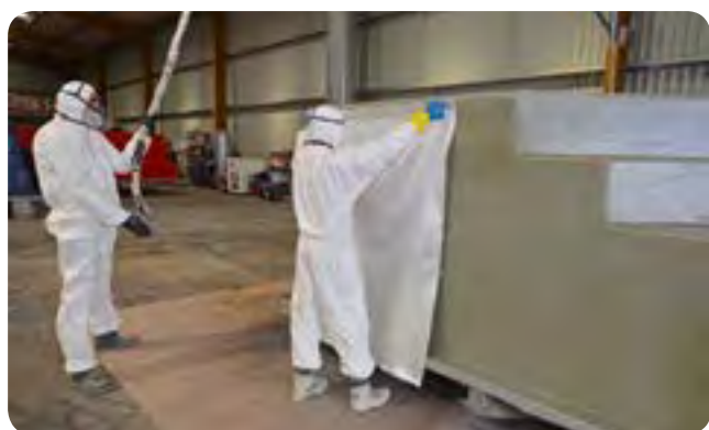
Application des mats de verre avant projection de la résine
