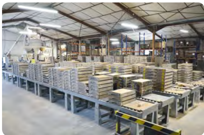
Les moules remplis, en phase de séchage
