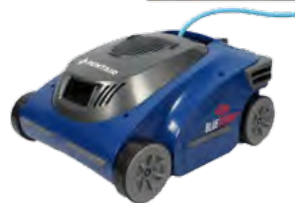
Le BlueStorm de PENTAIR opère des déplacements multidirectionnels grâce à ses jets hydrauliques orientables (Multi-JetNav) et la détection d'obstacles. Il est conçu pour engendrer le moins de frais d'entretien possible.
