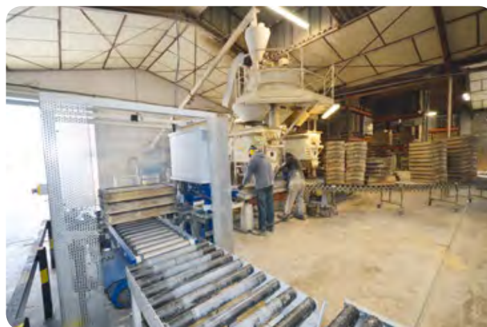
Après remplissage des moules, ceux-ci sont entraînés vers l'automatisme
