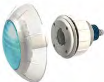
Le procédé Plug-in-Pool de CCEI fonctionne sur le principe de transmission d'énergie électrique sans fil par induction. Le couplage entre l'embase murale et la fiche évite de passer des câbles à travers la paroi de la piscine.
