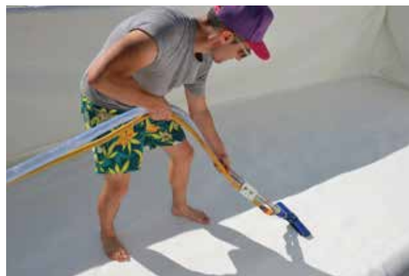
Exemple de nettoyage et de vidage de bassin hors-sol avec tête aspirante brosse avec grille inox
