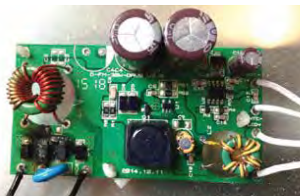
Une tension d'alimentation trop faible ou trop forte provoque un stress thermique aux composants électroniques : la carte électronique du driver affiche alors un ou plusieurs composants cassés ou brûlés
