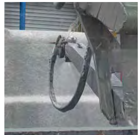
Gros plan sur la technique de la projection simultanée
