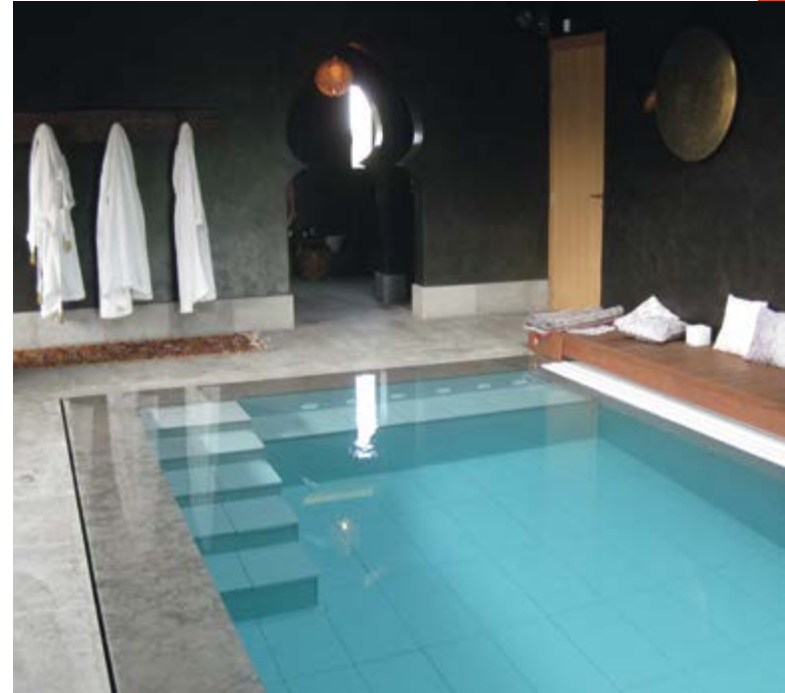
Piscine d'intérieur béton, miroir, carrelage gris, volet automatique, Régulation Poolrelax Bayrol (brome) (Sarda Piscines - 66)
