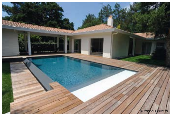
Piscine maçonnerie + membrane armée 150/100° (anthracite), 8 m x 4 m - escalier 4 marches (le caillebotis sur coffret volet sert de plage immergée), électrolyse du sel + régul pH, pompe à chaleur (12 kW), plage caillebotis IPE. (Eden Pool / Piscines de France - 40)
