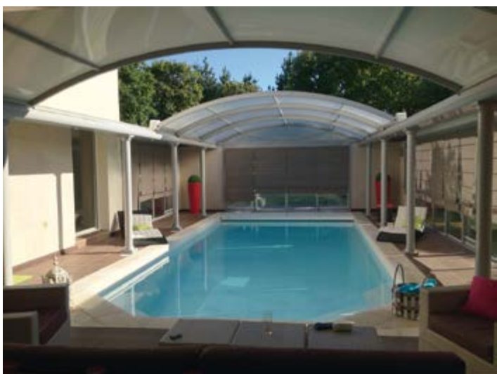
Coque polyester - modèle Agatelo 10 x 4.05 m, profondeur 0.80 m x 1.74 m. Intégration réussie avec abri haut télescopique. (Alliance Piscines)
