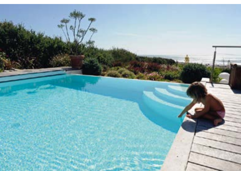
Piscine maçonnerie + membrane armée 150/100° (sable), 6,70 m x 5 m. Couverture automatique (blanche), filtre sable, électrolyse sel, pompe à chaleur (8 kW) (Gadin / Piscines de France - 17)
