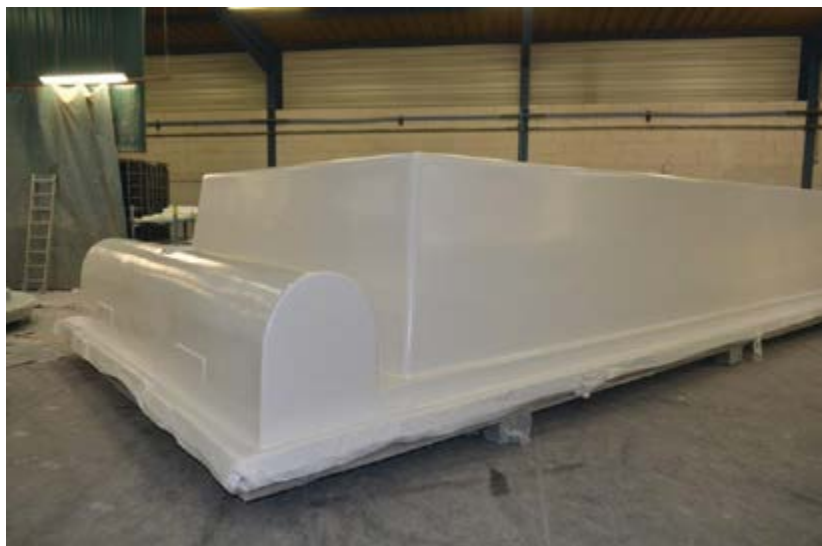
On aperçoit ici, dans le prolongement de la coque, le logement prévu pour recueillir un volet roulant. À noter, ce fabricant est le premier, il y a plus de 25 ans à avoir fabriqué une coque avec intégration d'une couverture automatique. (Mediester)
