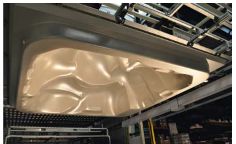
▲ Thermoforme d'une cuve de spa ▲
