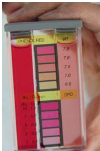
Trousse de contrôle (pastilles DPD), à gauche rouge foncé = bonne teneur en oxygène actif, à droite rose clair = bon pH (7,2/7,4)
