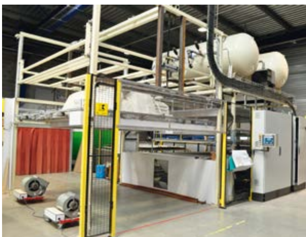
▲ Thermoforme d'une cuve de spa ▲
