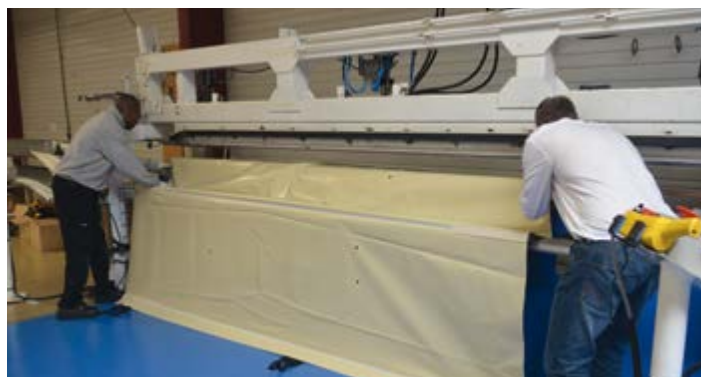
▲ Poste de fabrication des couvertures à barres
