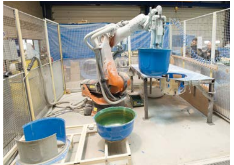
▲ Fabrication des filtres RTM ▲
