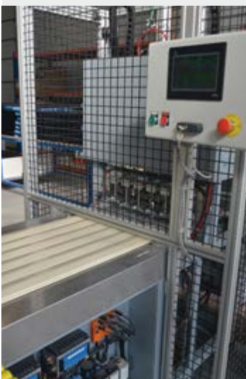
Machine de soudure miroir automatique des embouts
