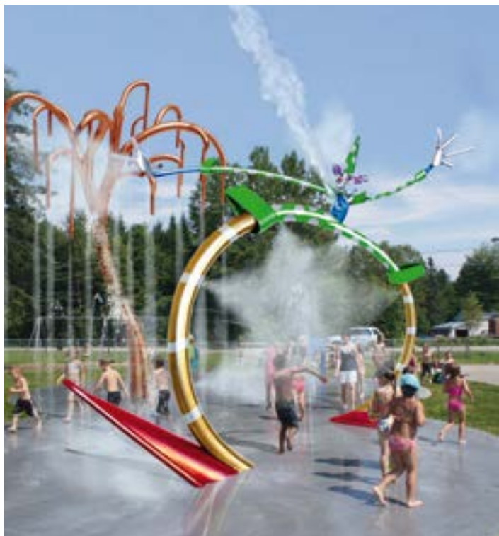
Anneau Clown : brumisation en périphérie de l'anneau Saule Pleureur : arrivée d'eau dans chaque branche du saule. On aperçoit également des jets de sol directement intégrés dans la dalle ( Dalle de jeu humide Diffasplash )
