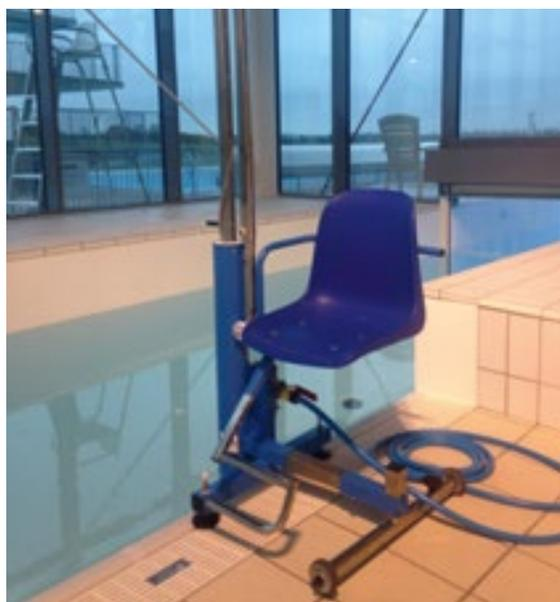
*L'ascenseur Lift LMP Hydraulique de La Maison de La Piscine assure une entrée dans l'eau autonome. L'utilisateur peut en toute sécurité effectuer son entrée dans l'eau après une rotation du siège à 180°. Il fonctionne sans électricité, avec une arrivée d'eau de ville.*
