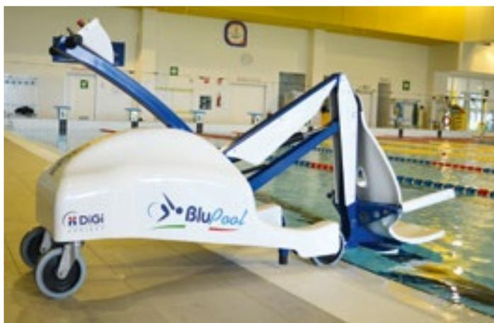
Le Blupool de Digi Project (distribué par Axsol) est un élévateur mobile sur batterie doté d'une capacité de levage de 1 400 mm et d'une capacité d'immersion de 820 mm. Sa charge maximale est de 140 kg, avec une course du bras de 1 400 mm, pour un temps de descente dans l'eau de 25 secondes et une sortie en 18 secondes. L'appareil fonctionne avec une batterie 24 V avec chargeur externe.
