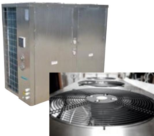
Créées pour une utilisation intensive, elles sont pourvues d'un échangeur en titane, une carrosserie haute résistance en inox (à partir du modèle 50kW), un afficheur déporté, un évaporateur traité et protégé, et sont chargées en gaz réfrigérant R410A. Les équipes commerciales de l'entreprise, formées à l'ensemble des gammes et présentes sur tout le territoire, sélectionnent pour chaque projet la solution de chauffage optimale, après étude personnalisée et bilan de puissance.
