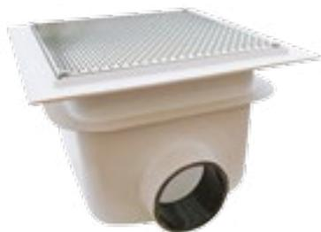
Conçues pour des débits allant de 17 à 84 m<sup>3</sup>/h, les bondes de fond sont produites à l'aide de résines antibactériennes et par un procédé RTM garantissant un côté lisse des deux côtés, pour une parfaite étanchéité.
