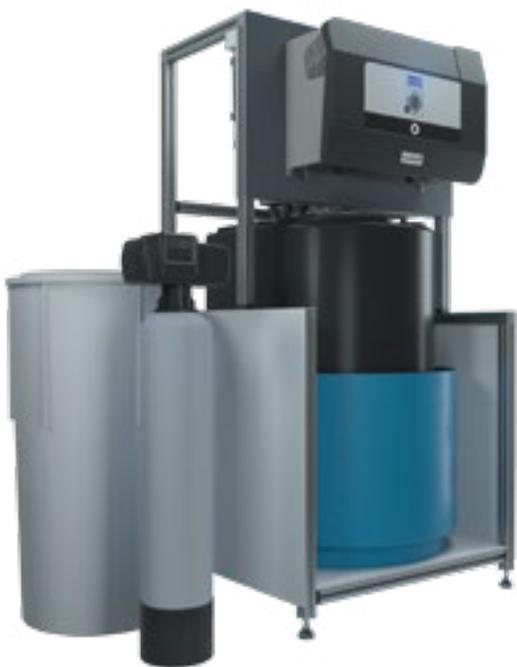
Le principe de ce générateur de chlore est de produire in-situ, dans le local technique, du chlore par électrolyse du sel. **Le chlore (hypochlorite de sodium) ainsi généré est stocké dans un réservoir d'attente, puis injecté dans le bassin, au fur et à mesure des besoins, grâce à une pompe doseuse pilotée par une régulation automatique.** Cette dernière permet de maintenir le chlore à
