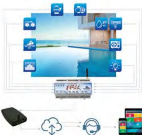
**FR** Polyconnect Pro, développé par POLYTROPIC, est un système de gestion à distance d'un parc de piscines qui communique par ondes radiofréquences entre le coffret piscine et la box internet, et par internet via les serveurs de Polytronic vers un Smartphone, une tablette ou un ordinateur. Cette solution connectée au service des professionnels centralise et affiche en temps réel toutes les données des équipements connectés à la piscine.
