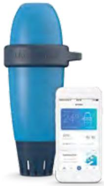
**FR** L'analyseur d'eau connecté Blue Connect mesure les paramètres principaux de l'eau d'une piscine ou d'un spa et les envoie en temps réel sur un Smartphone ou une tablette via l'application dédiée et le réseau radiofréquences Sigfox. Il peut être utilisé en objet flottant directement dans la piscine ou installé dans le local technique, avec l'accessoire Blue Fit 50. ASTRALPOOL
