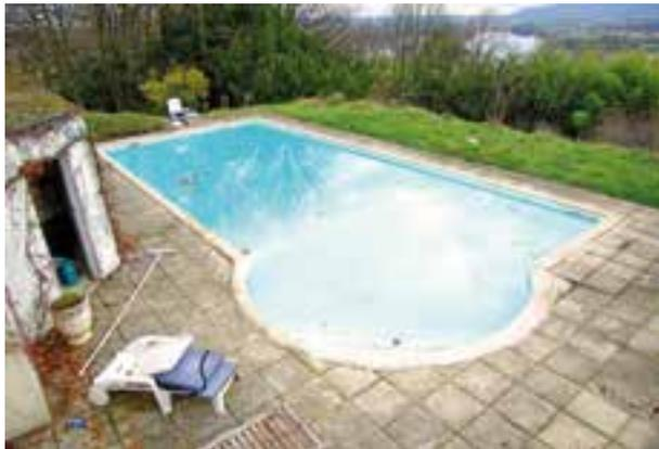
*Ainsi arrondi, l'escalier de la piscine ne convient pas pour la pose d'un volet flottant automatique qui recouvre entièrement le plan d'eau.*
