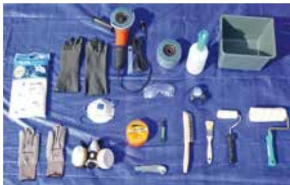
**Matériel :** Combinaison de travail, gants pour produit chimique et pour application, seau pour préparer résine + catalyseur, scotch orange, cutter, ébarbeur, rouleau, patte de lapin, doseur pour catalyseur, ponceuse, flaps, masque de sécurité et de ponçage, lunettes, mètre, pinceau plat, marqueur
