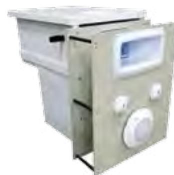
Idéal pour la construction de piscines en blocs polystyrène, blocs à bancher béton ou parpaings, ce mur filtrant **FILTRINOV** avec cartouche et pompe intégrées permet d'assurer la filtration des bassins jusqu'à 8 x 4 x 1,5 m. On remarque son skimmer à grande meurtrière, ses 2 buses de refoulement orientables et son projecteur Led couleurs (avec télécommande).
