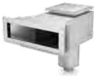
Le spécialiste suédois des équipements piscine, **PAHLÉN**, a lancé un nouveau skimmer pour les piscines résidentielles : le **Classic Wide 385**. Fabriqué en acier inox AISI 316 L, avec façade polie et compatible avec les liners, il dispose : d'un collier ajustable verticalement 30-70 mm, d'un déversoir en acier inoxydable, d'un raccord pour régulateur de niveau d'eau Ø 13 mm et d'un grand panier de filtration, haute capacité.
