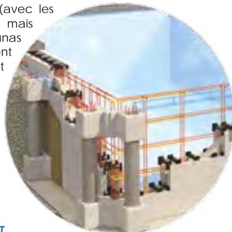
*Xtrem Bloc d'ASCOMAT se compose de banches reliées par des entretoises en polypropylène pour offrir une résistance hors-pair. La particularité de ce bloc à bancher isolant est son voile béton continu.*
