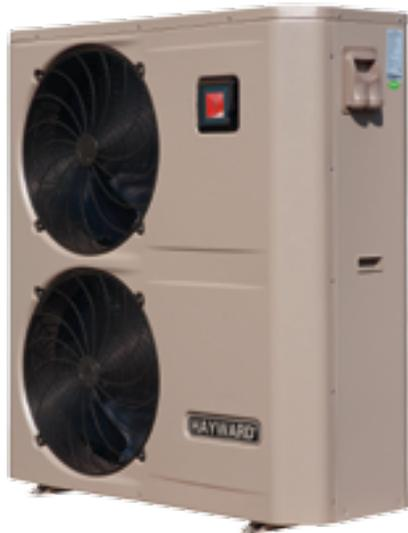
Elle s'avère idéale pour les piscines intérieures, ou en régions particulièrement froides. Le dégivrage automatique se fait par inversion de cycle. Produits plébiscités sur le marché, les pompes à chaleur de cette gamme offrent un rendement énergétique remarquable. Grâce à un système d'échangeur à double passe, le transfert de chaleur est optimisé, permettant d'avoir des COP supérieurs à 4.
