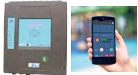
Bluetooth® par le biais d'une antenne optionnelle. L'utilisateur peut ainsi gérer l'ensemble des fonctions de sa piscine depuis son smartphone ou sa tablette et en contrôler les paramètres : température de l'eau, modulation des couleurs de l'éclairage... Tout ça, sans se déplacer jusqu'au local technique.
