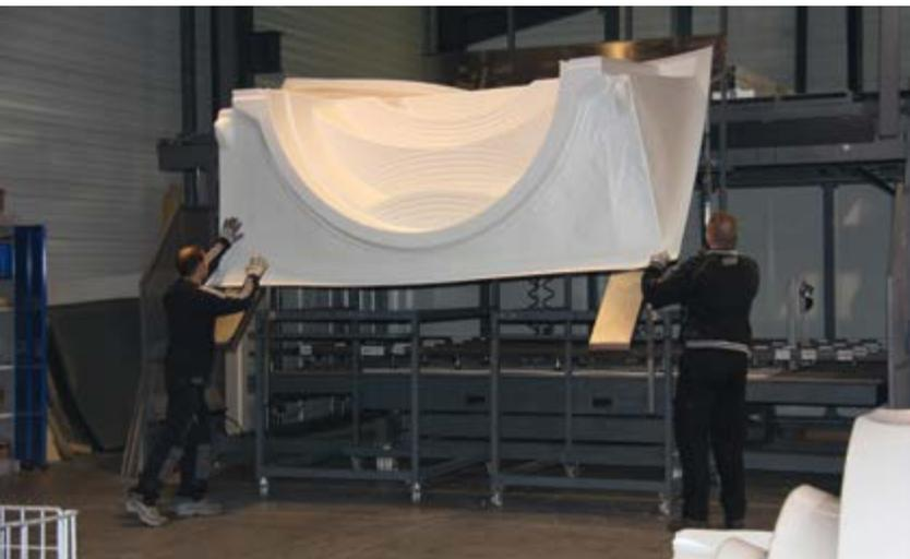
*Sortie d'un escalier thermoformé*
