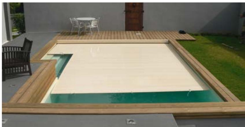
Couverture immergée Viana, volet en coffre sec. Système de fins de course intégré. (Wood)
