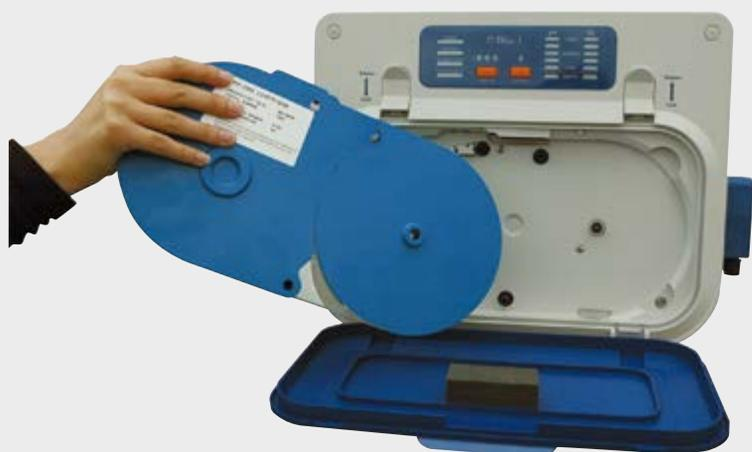
*L'entreprise française Ocedis propose la plus pertinente des méthodes d'analyses d'eaux de piscines, à la portée de l'amateur de haute technologie : la photolorimétrie. Toutes les 4 heures (ou bien 2 ou 8 heures), Prizma opère une analyse photométrique irréprochable (méthode colorimétrique DPD) et il injecte les justes doses pour corriger le pH et le chlore.*
