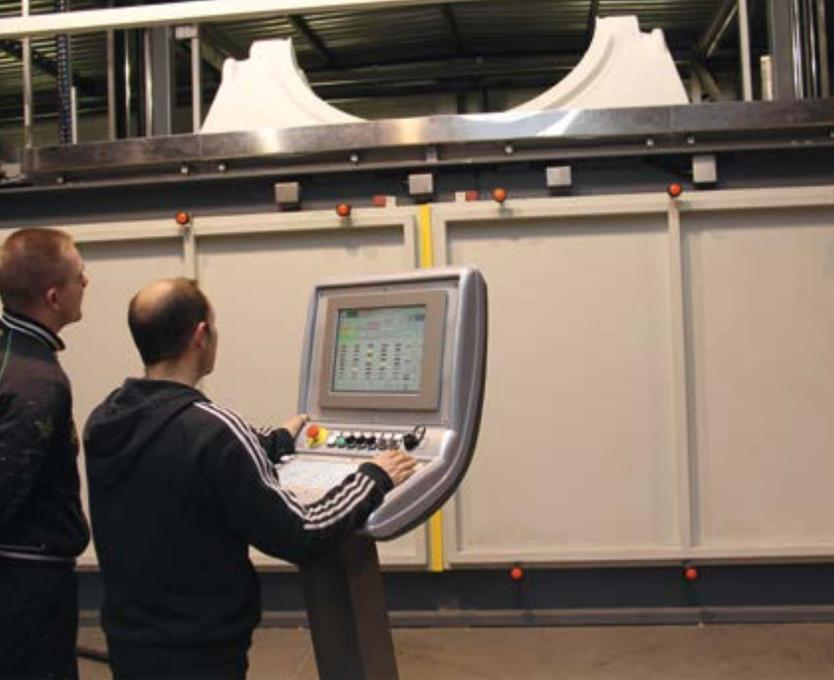
*Thermoformage d'un escalier en cours*
