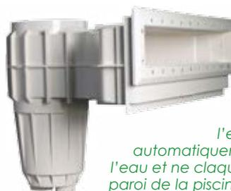
Skimmer d'une nouvelle conception qui fonctionne de manière similaire au débordement. L'ouverture très large (700 mm), associée au volet flottant, favorise l'aspiration de l'eau en surface. Le volet se règle automatiquement en fonction du niveau de l'eau et ne claque pas. Sa position est alignée à la paroi de la piscine ce qui fait que la circulation de l'eau est proche du fonctionnement du débordement périmétral. (**Pool's**)
