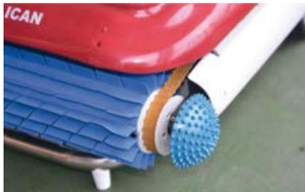
Rappelons que le Pelican fonctionne avec deux moteurs, un pour la traction et un pour l'aspiration, d'un débit de 15,5 m³/h, pouvant nettoyer des surfaces jusqu'à 300 m². Son tableau de commandes situé sur le coffret électrique permet la programmation pour un nettoyage de 3 h ou de 5 h, ou pour un fonctionnement manuel.
