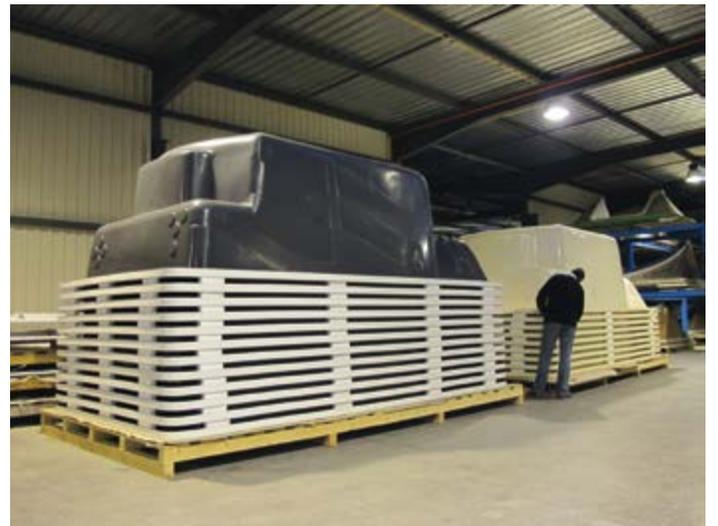
*Des mini piscines Pretty Pool thermoformées en attente d'un revêtement complémentaire polyester / fibres de verre pour renfort de la structure. Ce process de fabrication est unique en Europe.*
